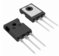
IXKH24N60C5 IXYS MOSFET N-CH 600V 24A TO247AD
