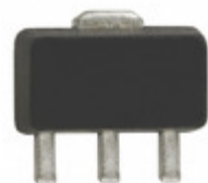
SGA-5489Z RFMD IC AMP HBT SIGE 4000MHZ SOT-89
