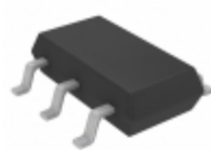
LT3462ES6#TRPBF ADI (Analog Devices, Inc.) IC REG CUK INV ADJ 0.25A TSOT23
