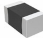
CQ0805ARNPOYBN1R0 Yageo CAP CER 1PF 250V NPO 0805
