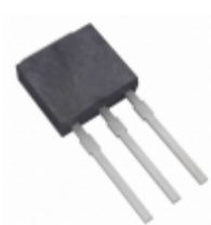
IXTU01N80 IXYS MOSFET N-CH 800V 0.1A TO-251
