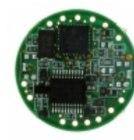
SM-MN-00-SPI Skyetek Inc MODULE M1 MINI W/SPI
