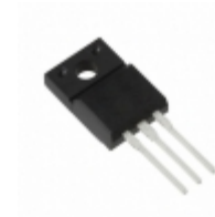
IXKP24N60C5M IXYS MOSFET N-CH 600V 8.5A TO220FP
