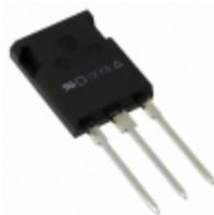
IXKR47N60C5 IXYS MOSFET N-CH 600V 47A ISOPLUS247
