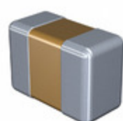
C0402C821J4HAC7867 KEMET CAP CER 0402 820PF 16V ULTRA STA
