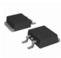
IRLZ14STRRPBF Vishay Siliconix MOSFET N-CH 60V 10A D2PAK
