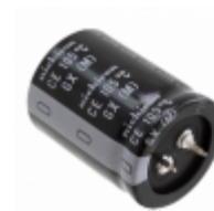
LGX2G391MELB40 Nichicon CAP ALUM 390UF 20% 400V SNAP
