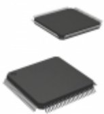
XC9572XL-10TQ100I Xilinx Inc. IC CPLD 72MC 10NS 100TQFP
