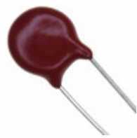
V250LT2 Littelfuse Inc. VARISTOR 410V 1.2KA DISC 7MM
