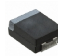
CWR29KC336KCXC AVX Corporation CAP TANT 33UF 10% 25V 2721
