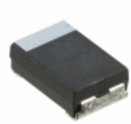
CWR29KB475KCFC AVX Corporation CAP TANT 4.7UF 10% 25V 2214
