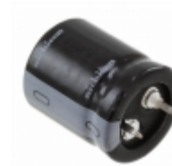
LQS2W820MELZ25 Nichicon CAP ALUM 82UF 20% 450V SNAP
