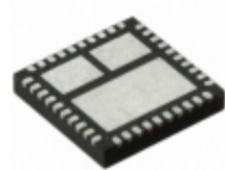
FDMF6823A Fairchild/ON Semiconductor MODULE DRMOS 60A 40-PQFN
