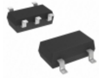
RT9169H-15GB Richtek USA Inc. IC REG LDO 1.5V 0.1A SOT23-5
