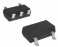
RT9073-25GU5 Richtek USA Inc. IC REG LDO 2.5V 0.25A SC70-5
