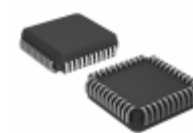
A3977SEDTR Allegro MicroSystems, LLC IC MOTOR DRIVER PAR 44PLCC
