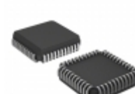
A3977SED Allegro MicroSystems, LLC IC MOTOR DRIVER PAR 44PLCC
