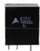
ETFV14K420E2 EPCOS (TDK) VARISTOR 680V 6KA RADIAL
