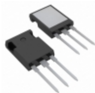
IXFR32N80P IXYS MOSFET N-CH 800V 20A ISOPLUS247
