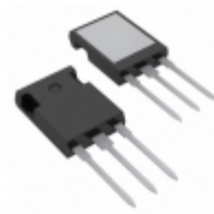
IXFR24N80P IXYS MOSFET N-CH 800V 13A ISOPLUS247
