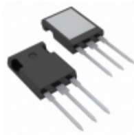
IXFR24N50Q IXYS MOSFET N-CH 500V 22A ISOPLUS247
