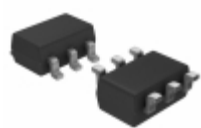
ISL3283EIHZ-T Intersil IC RCVR ESD RS485/422 LP SOT23-6
