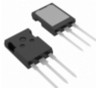
IXFX94N50P2 IXYS MOSFET N-CH 500V 94A PLUS247
