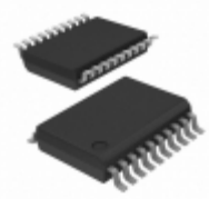
74ABT273ADB,112 NXP USA Inc. IC D-TYPE POS TRG SNGL 20SSOP
