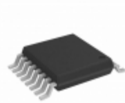
MC908QY8CDTE NXP USA Inc. IC MCU 8BIT 8KB FLASH 16TSSOP
