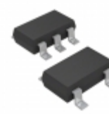
ADP165AUJZ-3.0-R7 Analog Devices Inc. IC REG LDO 3V 0.15A TSOT23-5
