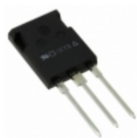
IXSR40N60CD1 IXYS IGBT 600V 62A 210W ISOPLUS247
