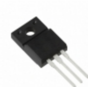
IXKP24N60C5M IXYS MOSFET N-CH 600V 8.5A TO220FP
