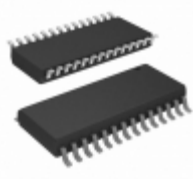
MC908JL16CDWER NXP USA Inc. IC MCU 8BIT 16KB FLASH 28SOIC
