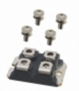
IXTN60N50L2 IXYS MOSFET N-CH 500V 53A SOT-227
