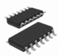
74LV86D,118 NXP USA Inc. IC GATE XOR 4CH 2-INP 14-SO
