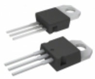
BDW84C-S Bourns Inc. TRANS PNP DARL 100V 15A
