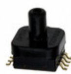
MPXHZ6115AC6T1 NXP USA Inc. SENSOR ABS PRESS 16.7PSI MAX
