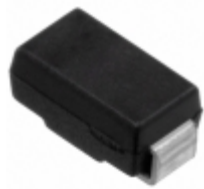
SJPL-L2V Sanken DIODE GEN PURP 200V 3A SJP
