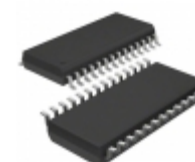
AD5725ARSZ-500RL7 Analog Devices Inc. IC DAC 12BIT QUAD PAR 28-SSOP
