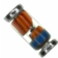
DL5232B-TP Micro Commercial Co DIODE ZENER 5.6V 500MW MINIMELF
