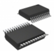
ATSAML11D15A-YUT Micrel / Microchip Technology IC MCU 32BIT 32KB FLASH 24SSOP
