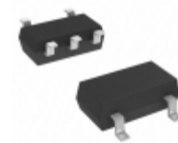
RT9080N-18GJ5 Richtek USA Inc. IC REG LDO 1.8V 0.6A 25TSOT
