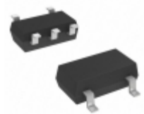
RT9080-18GJ5 Richtek USA Inc. IC REG LDO 1.8V 0.6A 25TSOT
