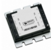
VI-JW1-MY-F1 Vicor CONVERTER MOD DC/DC 12V 50W
