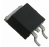
IXTT75N20L2 IXYS MOSFET N-CH 200V 75A D2PAK
