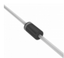
BZW04-7V0-E3/54 Electro-Films (EFI) / Vishay TVS DIODE 7.02V 12.1V DO204AL
