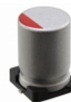
RHS0E152MCN1GS Nichicon CAP ALUM POLY 1500UF 2.5V SMD
