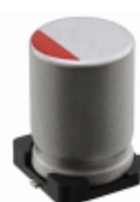
RHS0E821MCN1GS Nichicon CAP ALUM POLY 820UF 20% 2.5V SMD
