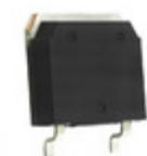
IXFT140N10P IXYS MOSFET N-CH 100V 140A TO-268
