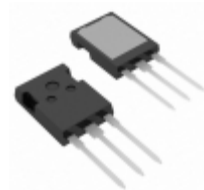
IXFX200N10P IXYS MOSFET N-CH 100V 200A PLUS247
