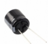
URS2D470MHD6 Nichicon CAP ALUM 47UF 20% 200V RADIAL
