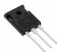
IXFH170N10P IXYS MOSFET N-CH 100V 170A TO-247
