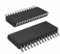
PIC18F24K40-I/SO Microchip Technology IC MCU 8BIT 16KB FLASH 28SOIC
