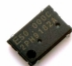
SG-8002JF 40.0000M-PCMB ROHS Epson OSC XO 40MHZ CMOS SMD
