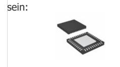
RT9945GQW Richtek USA Inc. IC LI-ION CHARGE MGMT 40WQFN
