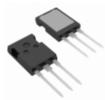
IXFX32N90P IXYS MOSFET N-CH 900V 32A PLUS247
